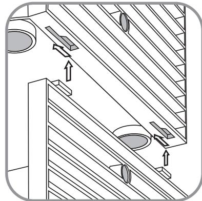
本体底面の[たて連結穴]に、本体上部の[たて連結つめ]を差込み、前方にスライドさせて連結します。
